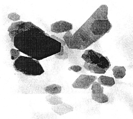
Fig. 1. TEM of kaolin fillers.
